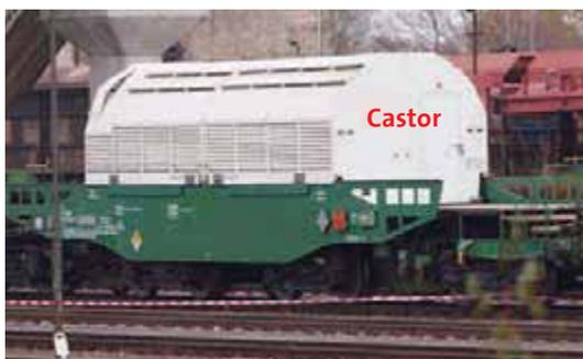
So sieht ein Castor-Behälter aus. Der größte Teil des Transportes erfolgt über das Schienennetz.
